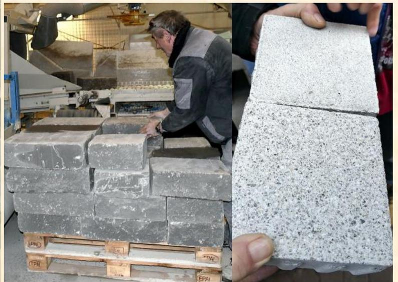
Die Steine werden auf Paletten gestapelt. Rechts: Stein mit Oberflächenschliff, vorher und nachher.
