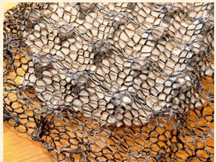
Dieses lockere Gestrick aus Kohlefasern formt Buck über Eierkartons und verfestigt es hinterher mit Thermoplastharz, so dass es die Form behält. Dann kann es statt der üblichen Eisengitter als Armierung (Festigungseinlage) in Beton kommen. Der Vorteil ist, dass es leichter ist und nicht (wie Metall) rosten kann, wenn Wasser eintritt. Das geht auch mit Basalt!
