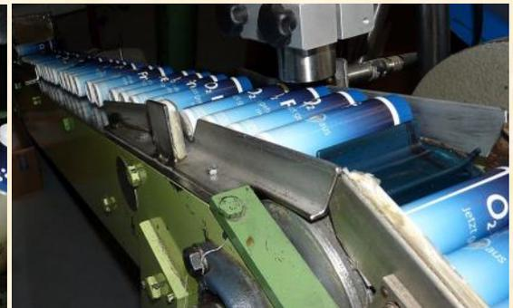
Zuerst werden die Döschen in einer Maschine mit Farbe bedruckt. Dort kann Werbung (auch für Privatkunden) aufgespritzt werden. Dann kommen sie zur Einfüllstation. Zuletzt werden sie zur Verpackungsstation transportiert und dort für den Versand verpackt. Die komplette Weltproduktion wird in Kilchberg bewältigt und von dort in alle Länder verschickt.
