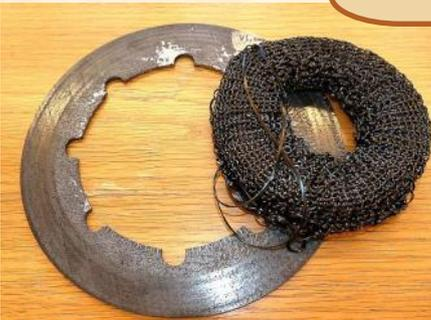
Das ist ein gestrickter Kohlefaserring. Aus ihm werden zusammen mit 2000°C heißem Silicium Keramikbrems Scheiben gemacht. Die sind hochwertig und extrem teuer!
