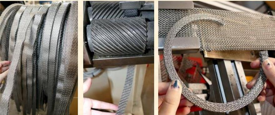
Die Bänder links werden mit Metallgestrick ummantelt und danach gewalzt und geformt. Die fertigen Ringe braucht man als Dämpfung für die Auspuffe von Autos und LKWs. Dann klappern diese nicht. Diese Ringe sind sehr stabil, elastisch und rosten nicht. In jedem 6-Zylinder-Diesel von Mercedes ist ein Dämpfungsring von Buck.
